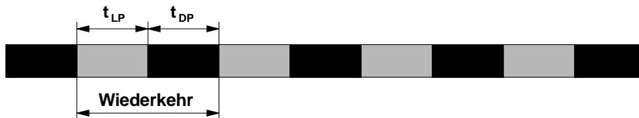
Abbildung 23: Kennung eines weißen Gleichtaktfeuers
